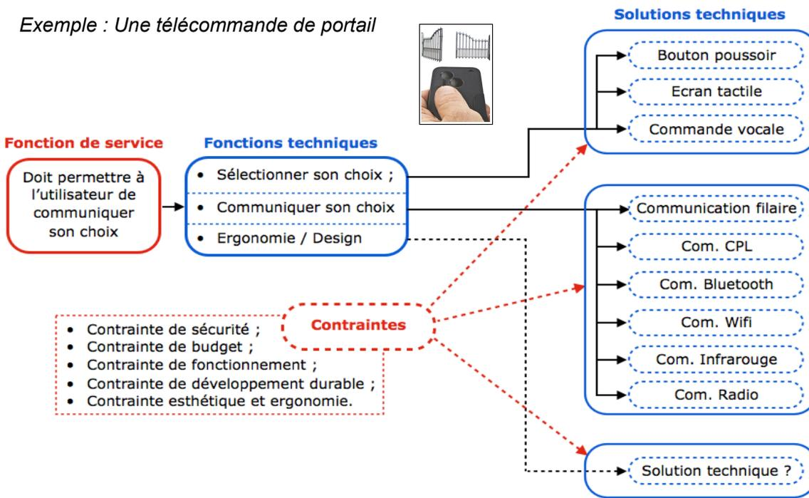
NB : La solution idéale paraît être une télécommande à bouton avec une communication infrarouge ou radio car ce type de solution fonctionne à une distance satisfaisante, avec un niveau de sécurité correct et elle est réalisable avec un budget réduit.
